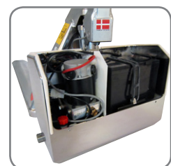
Wasserfeste Kapselung des Hubmotors (EHL RF-PLUS).
