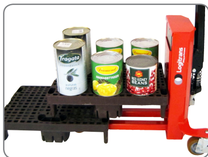
Le modèle LogiQ 300 peut manipuler le quart de palette se situant tout au-dessus sans aucune difficulté.
