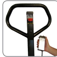
Die Kippfunktion wird durch die Kabelfernbedienung gesteuert.
