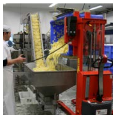
Rotator beim Einsatz in der Lebensmittelindustrie.
