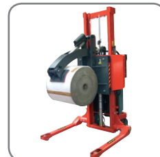
Le Rotator Pince-bobines permet de transporter des bobines lourdes, de les soulever et de les faire tourner dans chaque sens avec un angle de 90°.
