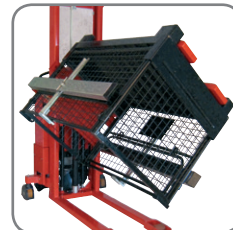
Inclinées à 180° et maintenues avec les attaches, les caisses sont vidées en toute sécurité.
