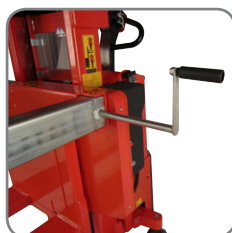
Bras de maintien variables : la largeur s'ajuste à l'aide de la manivelle pour s'adapter aux largeurs de caisse souhaitées (entre 800 mm et 1200 mm).
