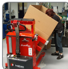
Des conditions de travail optimales : l'utilisateur peut atteindre le contenu sans devoir se contorsionner au risque de se blesser le dos.
